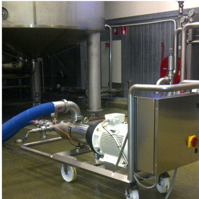
HYGHSPIN als mobile Einheit zur Tankentladung
